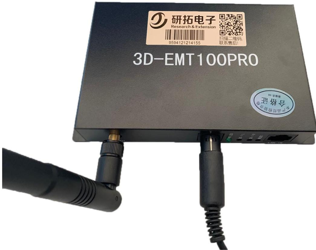
产品描述:本同步 3D 立体信号发射器,采用 2.4GHz 射频作为无线通信媒介,它通信距离远,并可 360 度无死角覆盖,信号稳定可靠,是 LED 大屏、拼接融合、展馆、
