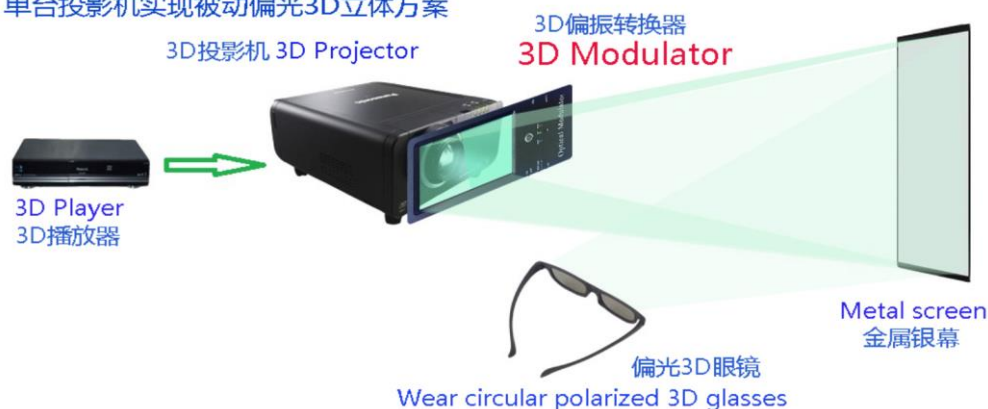
图 1 单机偏光立体 3D 方案基本组成(单光路)
