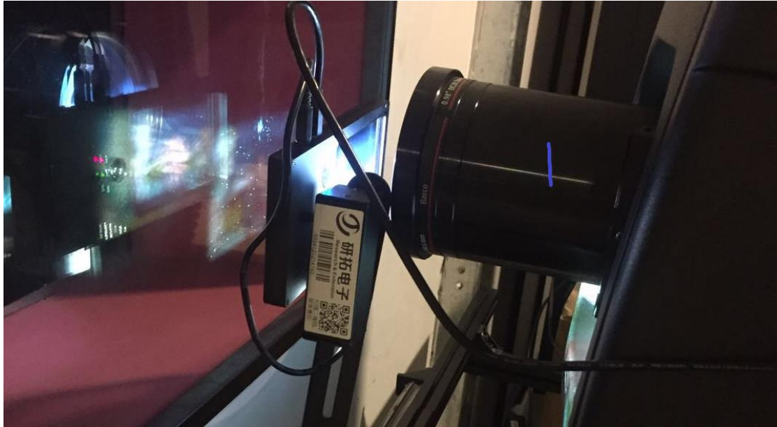
图 2. 科视放映机安装全自动单光路偏光 3D 设备现场
