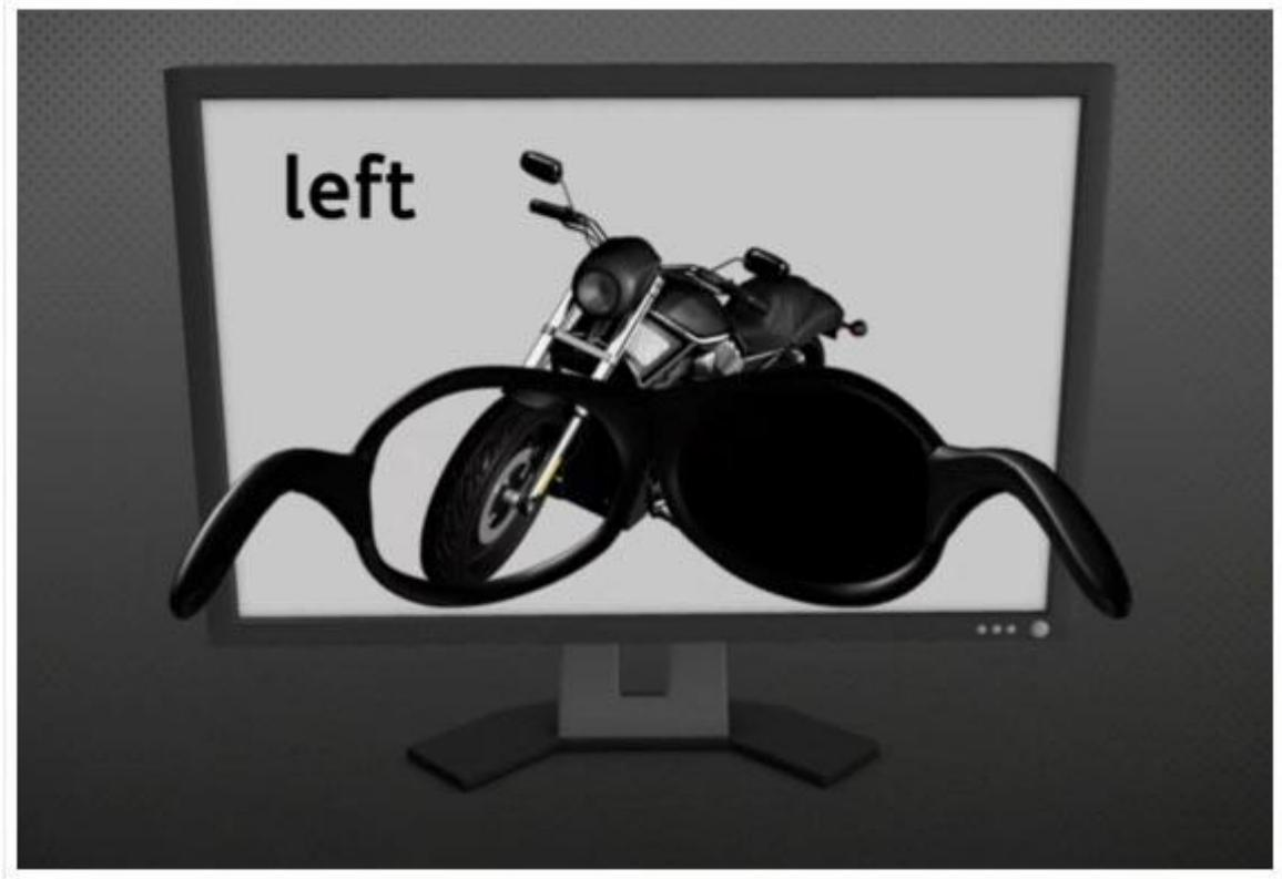
所谓主动式开关眼镜就是这些眼镜的镜片其实就是电子液晶开关，左右眼镜片相当于二个开关同步于放映系统。当放映机投影左画面时左镜片液晶开关打开，同时右镜片液晶开关关闭；反过来当投影右画面时，左镜片开关关闭，这样反复切换以达到分离立体影像的目的。上图所示为液晶开关眼镜原理图。
